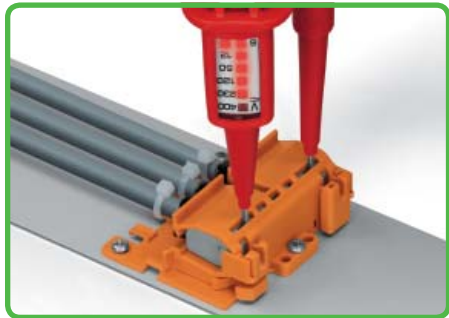
固定用アダプタにはコネクタのテスト用穴位置に穴が開いており、取りつけた状態でも導通テストができます。
