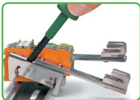
ブスバーキャリアの取外しには刃先 5.5 mm のドライバ (型番 : 210-721) を使用します。
